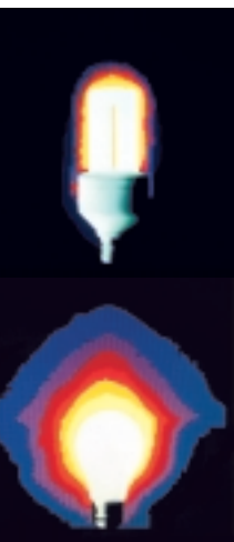
Wärmebildaufnahme von Energiespar- und Glühlampe
